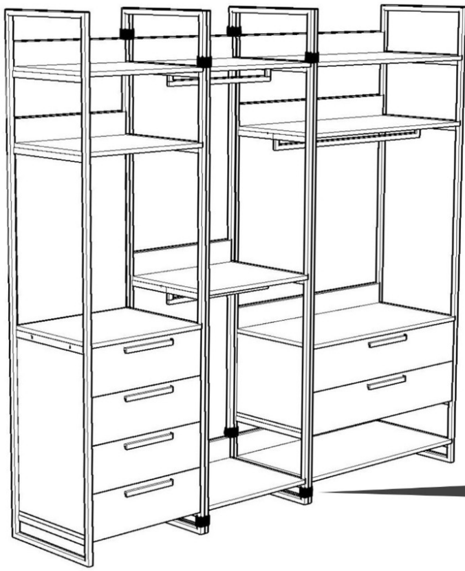
MODÜL BİRLEŞTİRME DETAYI (MODULE FIXING DETAIL)
